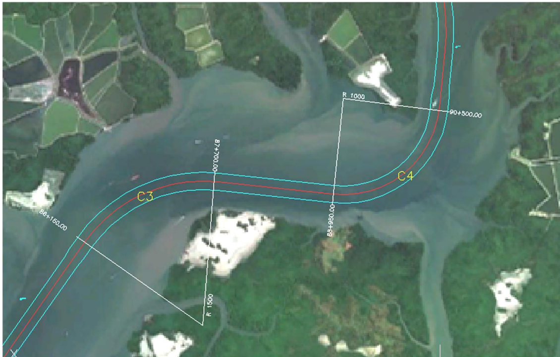
Figura 14. Curvas en la Zona de Cuarentena - antepuerto, comprendidas entre el cadenamiento 86+150-87+750 y 88+950-90+500, respectivamente.
