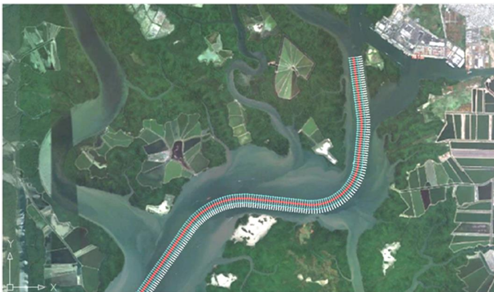
Figura 34. Canal propuesto sobre imagen satelital, área de Cuarentena, comprendida entre la Boya 75 (85+100km) y la Boya 85 (92+800)
